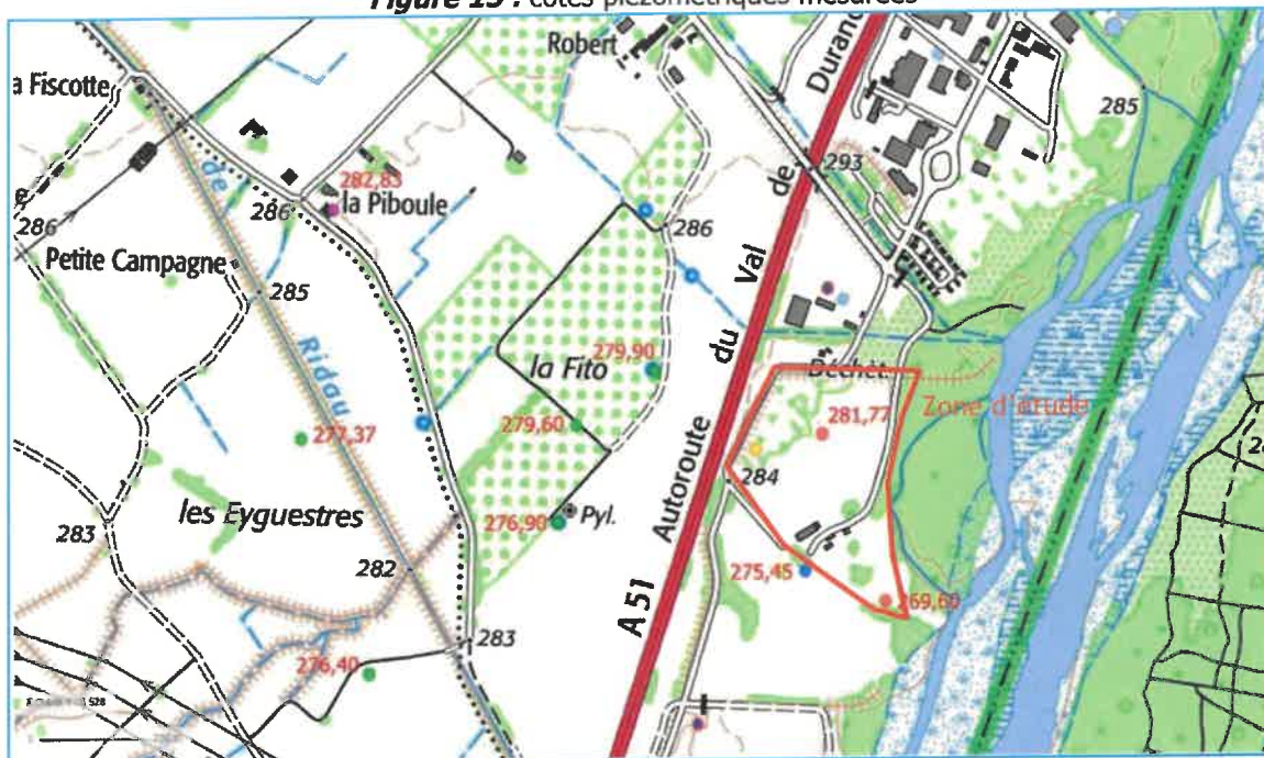
Figure 13 : cotes piézométriques mesurées
